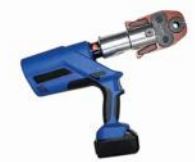
5 - Layer pipe charging press
